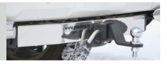
Тип шара «Е»; Тип соединения: шаровый; Диаметр сцепного шара: 50 мм.; Масса комплекта ТСУ ТРR991101: 18,3 кг.
