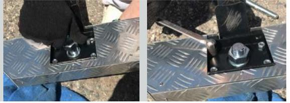
**ШАГ 3.** Установите кронштейн фаркопа в сборе с подножкой в приемное отверстие фаркопа. Отрегулируйте положение подножки. Затяните все резьбовые соединения.
