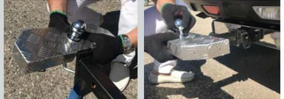
**ШАГ 4.** Установите палец для фаркопа и зафиксируйте его шплинтом пружинным.
