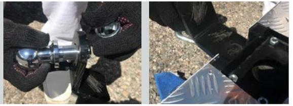
**ШАГ 2.** Совместите отверстие кронштейна фаркопа и подножки под шар. Вставьте шар и прикрутите его гайкой с гровером на 38 мм. Подтяните прижимную пластину гайками М8. Соединения не затягивать.
