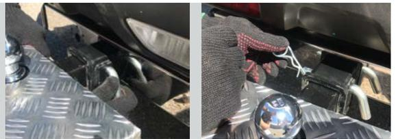
**ШАГ 5.** Зафиксируйте кронштейн фаркопа болтом М10х20 снизу.
